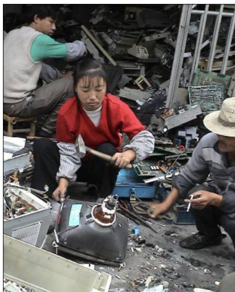
Guiyu (Guangdong), Chine : une femme est sur le point de briser un tube cathodique d'un écran d'ordinateur, afin d'enlever le joug chargé de cuivre, au bout de l'entonnoir. Le verre est chargé de plomb, mais l'aspect le plus dangereux d'une telle activité provient de l'inhalation de la couche interne de poussière de
