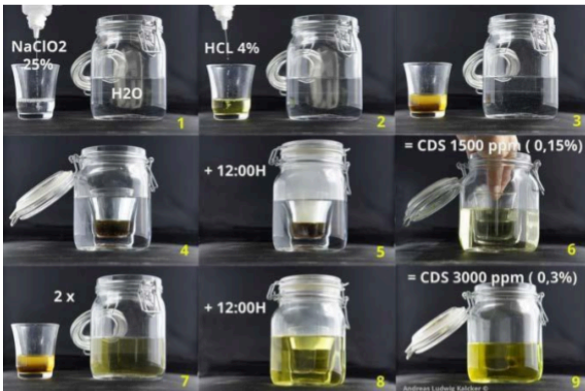
Fig. 50 : Préparation du CDS en utilisant l'acide chlorhydrique comme activateur
